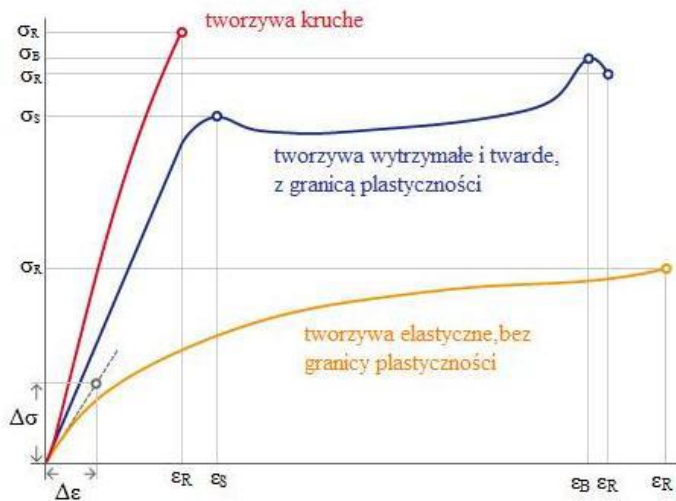
Rys. 1. Typowe krzywe naprężenie – wydłużenie dla różnych materiałów
