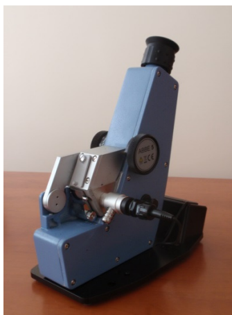
Rys. 2. Refraktometr Abbego (widok z dwóch stron)
