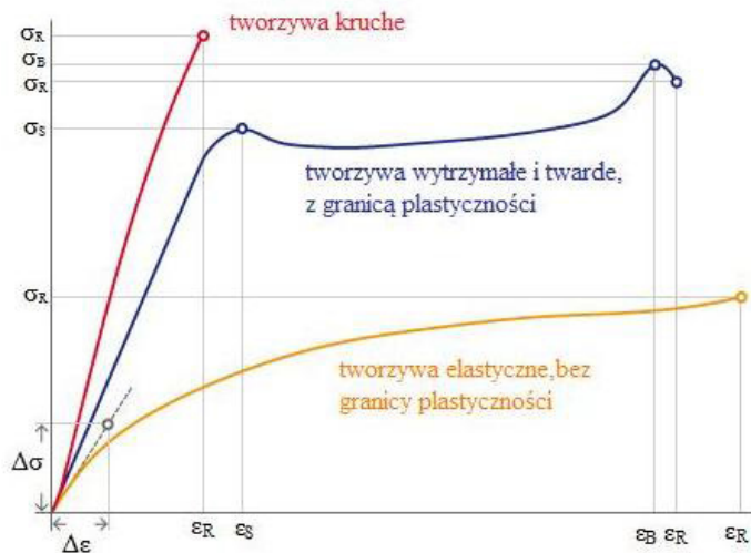
Rys. 1. Typowe krzywe naprężenie – wydłużenie dla różnych materiałów
