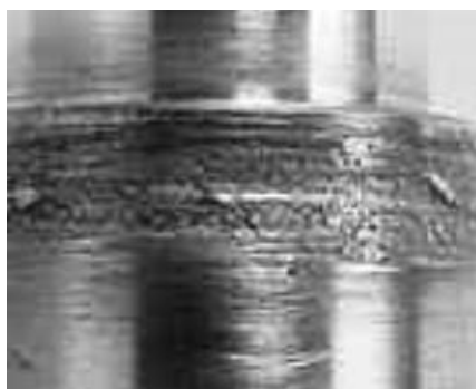
Rys. 6. Powierzchnia po zużyciu adhezyjnym
