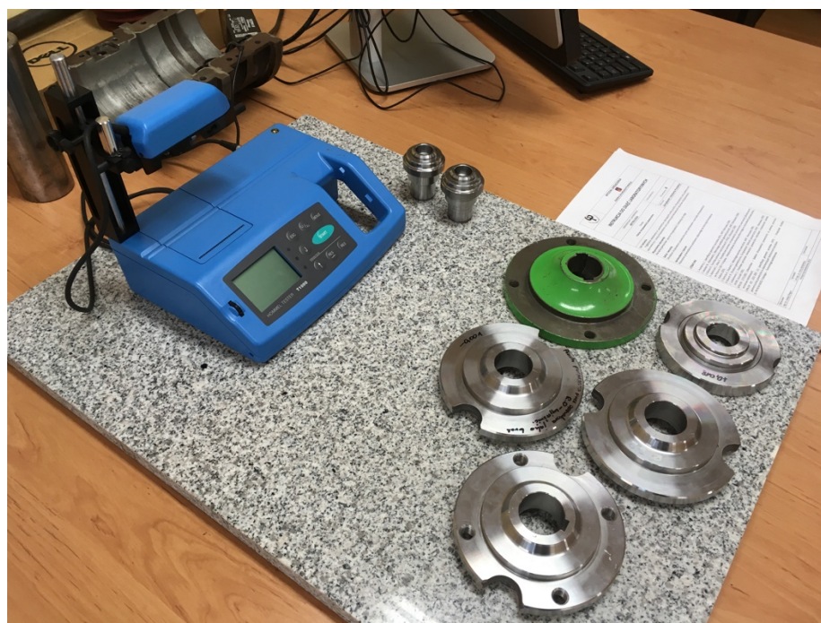
Rys.10. HOMMEL TESTER T1000 - profilografometr
